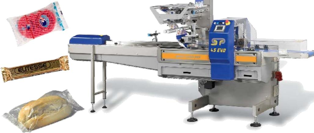
Ensacheuse flow pack en porte-à-faux à mâchoires rotatives pour produits alimentaires ou non. Cette configuration en porte-à-faux facilite le nettoyage de la machine lors d'un usage avec des produits salissants.
