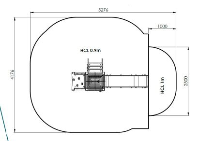
HCL 0.9m : 16.3 m<sup>2</sup> HCL 1m : 2.1 m<sup>2</sup>
