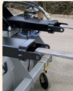
Kit d'accrochage sur fourreaux flottants avec fixations sécurisées
