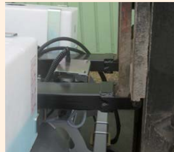
Kit d'accrochage sur fourreaux flottants avec fixations sécurisées
