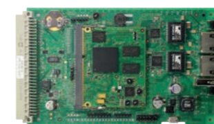
M-HYB-IP-RACK Interface Maylis vers réseau TCP/IP - version carte rackable REF 440.5750
