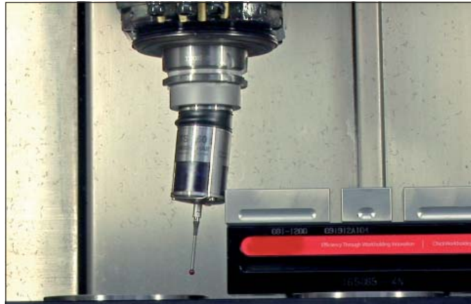
Un adaptateur de protection anti-collision protège le palpeur des dommages mécaniques...
