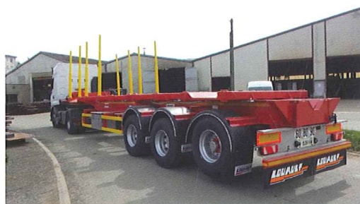
Essieu relevable arrière
