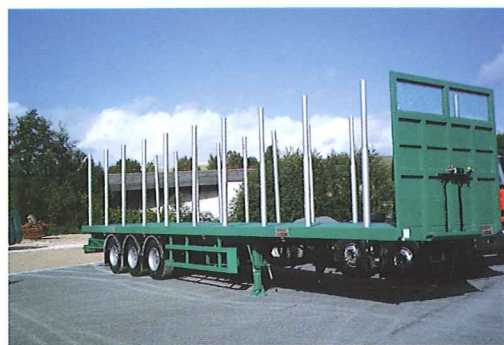
Semi-remorque porte bois avec face avant
