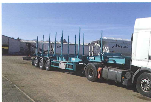
Semi-remorque porte bois avec réserve pour grue
