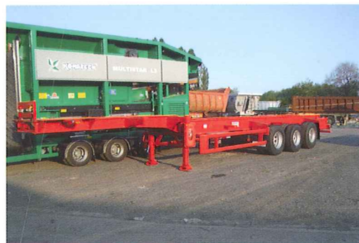
Semi-remorque porte bois châssis nu
