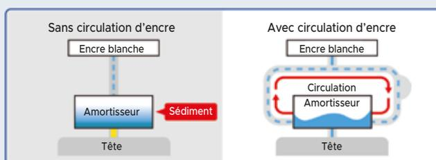
MCT Version 2 (Mimaki Circulation Technology Version 2) Circulation à travers le circuit d'encre, y compris l'amortisseur\*, prend en charge l'éjection stable de l'encre blanche pour réduire le nettoyage fréquent des buses et le gaspillage d'encre.
