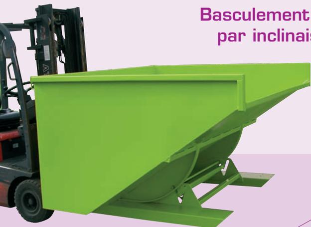
Basculement et retour automatique par inclinaison du mât du chariot.
