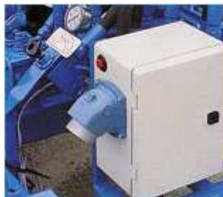
Asservissement du treuil à un ensemble de convoyeurs électriques - Position marche forcée ou marche associée aux convoyeurs.
