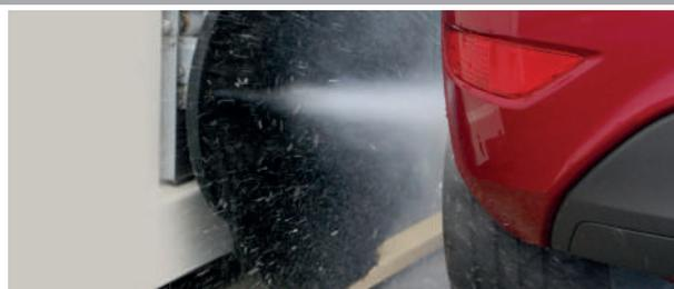
Les nouvelles buses tournantes Haute Pression 80 bar intégrées dans le lave-roues (4 ou 8 becs) permettent de nettoyer plus efficacement les jantes et l'ensemble du bas de caisse. Son double sens de rotation permet d'obtenir de meilleurs résultats sur les nouveaux design de jantes en alliage.
