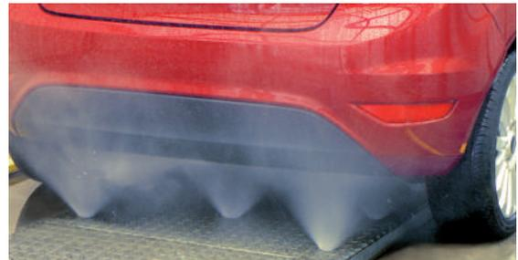
L'option idéale pour un lavage intégral pour vos clients les plus exigeants. Lavage châssis fixe 10 bar, 90 L/min, ou oscillant 15 bar, 120 L/min.
