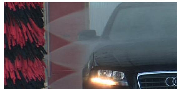
Une large gamme de prélavages haute pression pour préparer le véhicule pour un nettoyage parfait. Disponibles en: 15 bar et 120 l/min., 80 bar et 42 l/min. ou 80 bar et 84 l/min.
