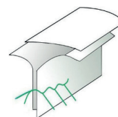
Coutures cousues et recouvertes d'une bande thermocollée
