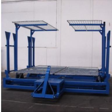
**Équipements de la remorque** Structure Mécano soudée pour résister à de fortes sollicitations, 2 rails en U pour permettre le guidage des roulettes des chariots manuels, 4 rampes d'accès pivotantes pilotés par des vérins à gaz. Cette remorque permet le déplacement simultané de deux chariots porte salons sur la même remorque : réduction des temps des déchargements. Chargement et déchargement en latéral grâce aux rampes.
