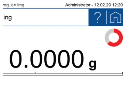
L'indicateur optique de stabilité indique les défauts de mesure et donne en temps réel des informations sur l'influence de l'environnement sur la balance.
