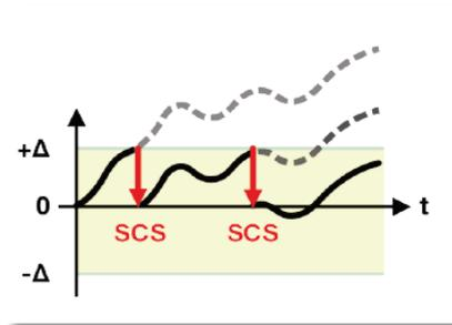
Le Système de Calibrage Interne (SCS) développé par PRECISA permet un ajustage/calibrage automatique de la balance. Cette fonction peut être programmée en fonction des changements de température et/ou à intervalles planifiés et ce dans le but de bénéficier pour l'utilisateur d'un instrument toujours au meilleur de sa performance. Cette option est souvent utilisée dans les environnements réglementés (GLP).
