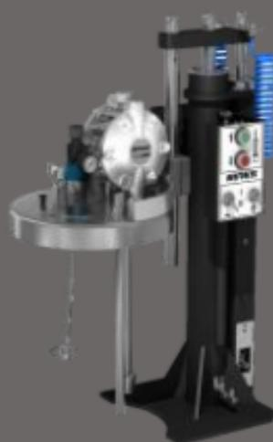
Montée/descente manuelle ou pneumatique avec blocage en position haute. Centrage de bidon adaptable suivant leurs tailles, couvercle inox sur mesure, bac de rétention. Arrêt automatique de l'agitation lors de la montée.
