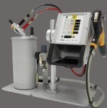
Équipement de poudrage conçu pour les petites séries avec des poudres difficiles. Équipé d'un petit réservoir fluidisé 4L.
