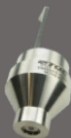
Détermine la viscosité par mesure du temps d'écoulement à travers un orifice calibré
