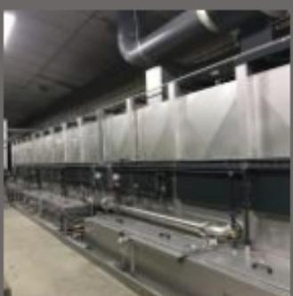
Le tunnel est composé de plusieurs étages: Traitement dégraissant phosphatant, dérochage, rinçage, passivation, conversion chimique.
