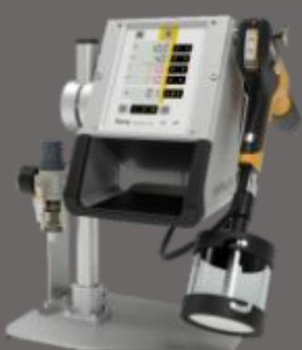
Équipement de poudrage conçu pour les petites séries ou les échantillons. Équipé d'un petit godet avec auto-fluidisation. Traitement de 20 à 250g de poudre.
