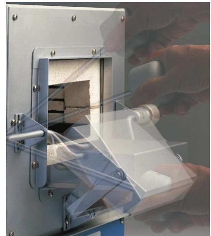
Détail du système d'ouverture basculante.
