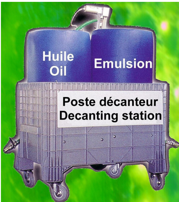
Station de récupération du soluble après décantation des émulsions.
