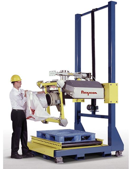
*Le design permet d' éviter de marcher sur les convoyeurs à rouleaux pour d'atteindre la tête de remplissage.*
