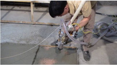
Fabrication de dalles en béton de fibres de verre
