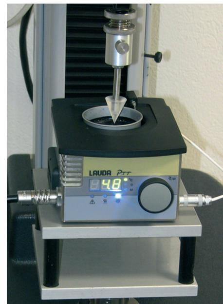
Test de pénétration avec un cône et un ensemble Peltier pour garantir une température de l'échantillon réglable entre +5°C et +80°C
