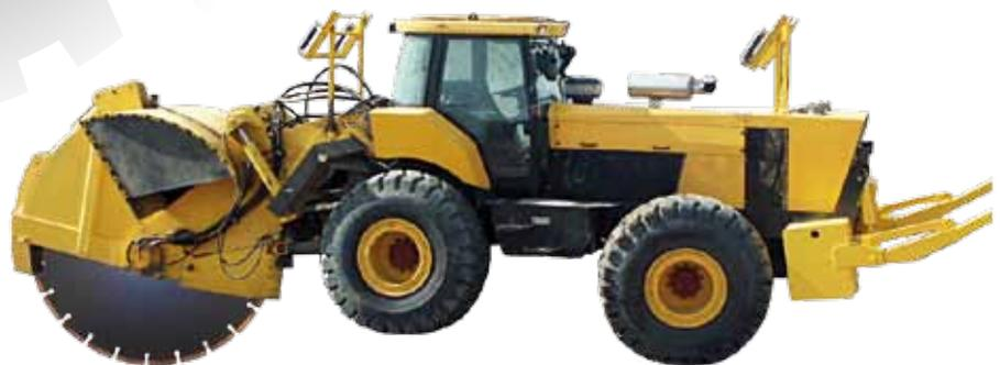
ultra-résistant à double entraînement central pour une durée de vie et une robustesse inégalées. Pour satisfaire aux différents besoins de largeur d'ouverture de tranchées, seuls les secteurs de roue doivent être interchangeables. De même pour la chaîne Alligator, il suffit de changer les pavés de chaîne pour modifier la largeur d'ouverture.
