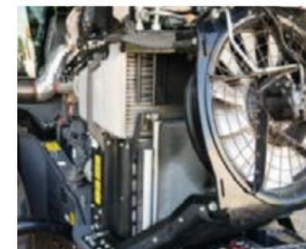
Grâce à un imposant intercooler et un échangeur de chaleur qui fait office de refroidisseur intermédiaire, la température de l'air d'admission est parfaitement régulée.
