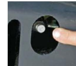
□ La pression de tension de la chenille peut être réglée confortablement en se branchant sur un raccord hydraulique facilement accessible sur le côté.
