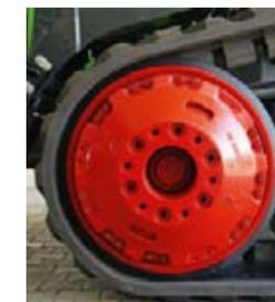
Les roues de guidage avant peuvent être lestées jusqu'à 1580 kg.
