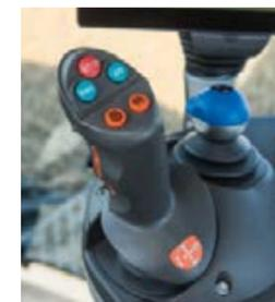
Le joystick multifonction (de série) contrôle la vitesse d'avancement, les vitesses Tempomat, la mémoire du régime moteur et la gestion des manœuvres en bout de champ.
