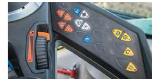
Le paramétrage de la transmission, du système hydraulique et de la PDF se fait à partir du panneau de touches situé sur l'accoudoir.
