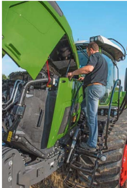
Le compartiment moteur est facilement accessible avec ses panneaux latéraux amovibles.
