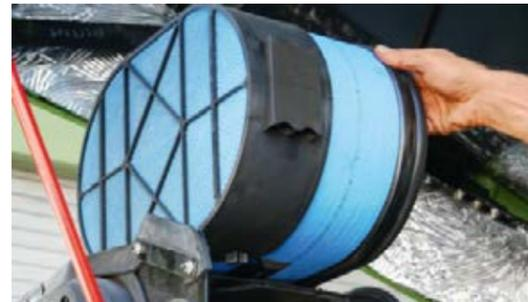
Le filtre à air est facile à remplacer et est équipé d'un capteur d'impuretés qui donne des renseignements sur l'efficacité du filtre.
