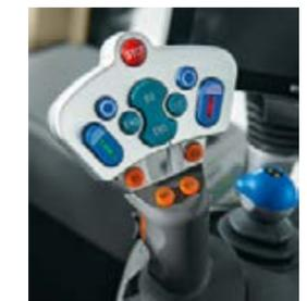
Le joystick Profi en option comporte également des boutons servant à commander deux distributeurs hydrauliques.
