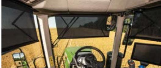
■ Les pare-soleil installés sur tous les côtés de la cabine protègent l'opérateur contre les reflets et disparaissent entièrement dans la garniture de toit.
