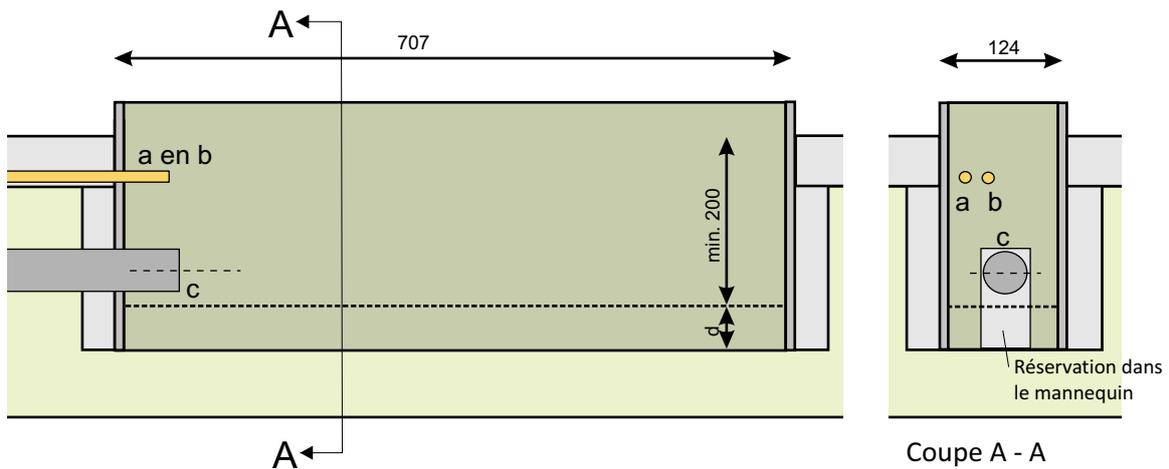
Placez le mannequin de 707 x 124 mm pour la réservation au bon endroit. Placez les canalisations eaux froides et eaux préchauffées (A et B), dans le ragréage de finition du sol, ou dans la finition flottante du sol. Remplissez jusqu'au mannequin. Mettez du ragréage pour la finition du sol. Enlevez le mannequin du sol.
