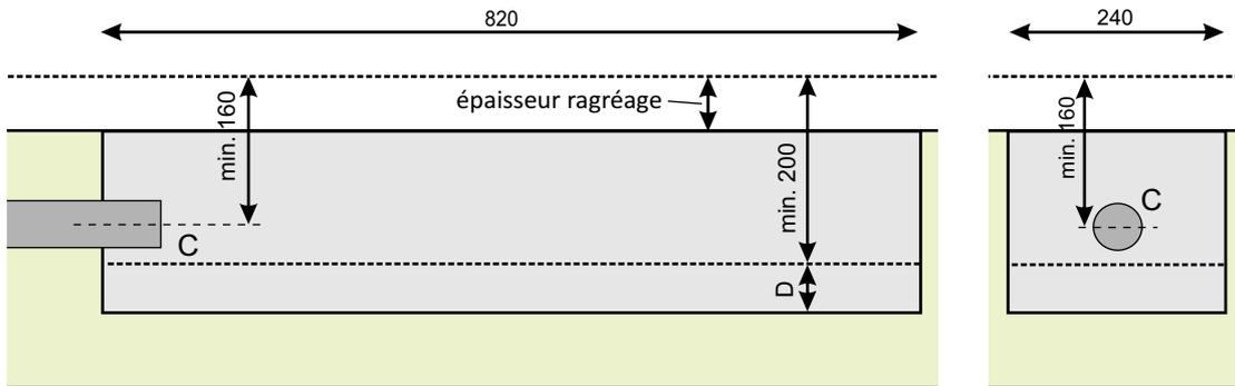
Dalle en béton avec une réservation de 820 x 240 mm et tube d'évacuation égout (C).
