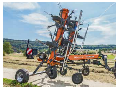
Les roues standards de l'essieu, des deux modèles, sont des pneus larges de 10.0/75 - 15.3 avec une voie de 2.45m.
