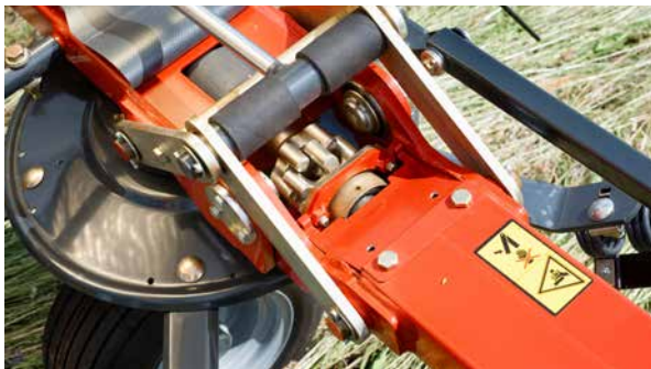
Entraînement à doigts HexaLink permettant un repliement au transport à 180°.
