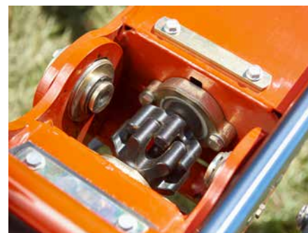
L'entraînement Fanex HexaLink permet un repliement à 180 ° des rotors extérieurs au transport.
