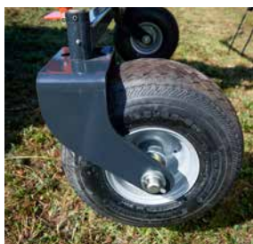
Nouvelle roue de jauge en option avec essieu tandem pour une grande précision dans le suivi du sol.
