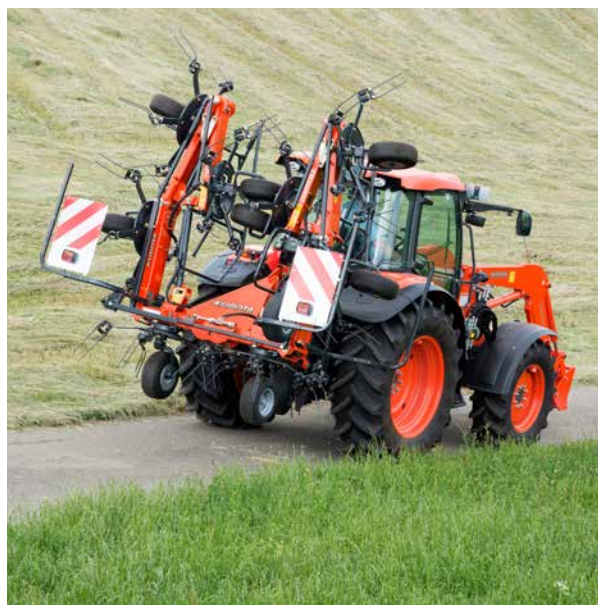
La TE8080 se replie au transport en position compacte.
