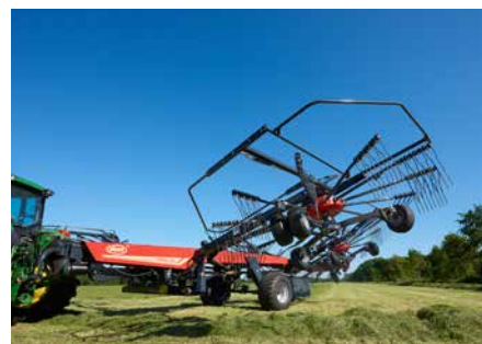
La hauteur de levage importante des rotors assure un dégagement généreux pour les demi-tours en bout de champ.
