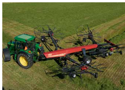
Les AnDEX 1254 et 1304 sont équipés pour prendre des virages serrés jusqu'à 80°.
