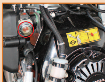
Carburateur avec système d'amorçage. Moteur avec sécurité d'huile
