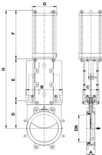
Actionneur designé pour une pression d'alimentation de 6 bar et pour la pression différentielle standard du catalogue
