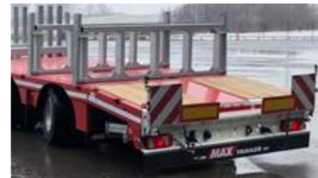
Un support galvanisé pour le plateau de chargement à la même hauteur que le col de cygne.
