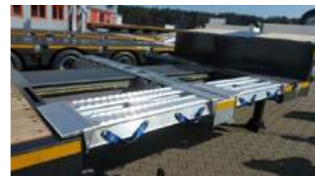
Eléments en ALU ± 1.160 x 420 x 120mm (pour une extension de 1.000mm) pour faire la jonction entre le plateau en position d'extension.
