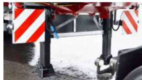
Panneaux de signalisation env. 423 x 423mm extensibles de \pm 400 mm avec 1 feu de position LED.
