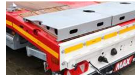
Cales de compensation galvanisées pour chanfrein 1.000 x 8° avec broches de fixation.
