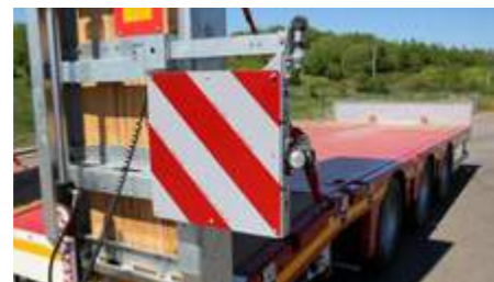
Panneaux de signalisation env. 423 x 423mm extensibles de ± 400mm avec 1 feu de position LED.
