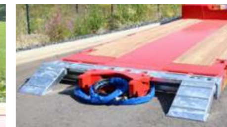
Rampes en acier pour passer au-dessus des crochets du plateau extra-surbaissé.
