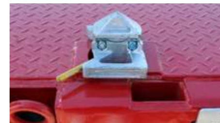
Pochettes conteneur WADER dans le plateau de chargement pour un conteneur 20". Fixations conteneurs WADER.
