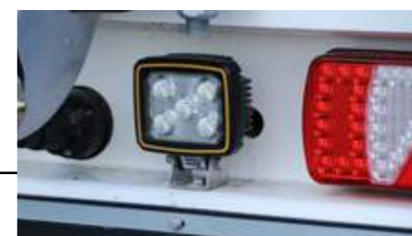
Phares LED installés sur la face arrière.
