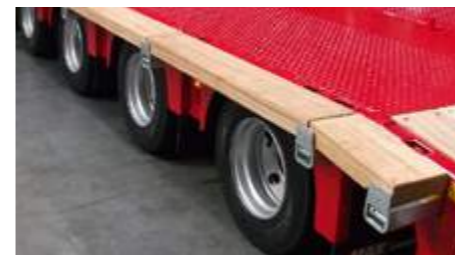
Elargisseurs galvanisés, extensibles d'env. 230mm par côté. Bastaings d'élargissement en bois dur.
