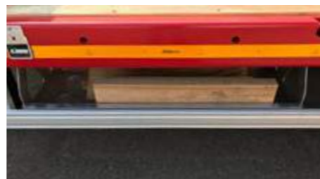
Un support galvanisé pour les bastaings d'élargissement à gauche et à droite en dessous du plateau de chargement.
