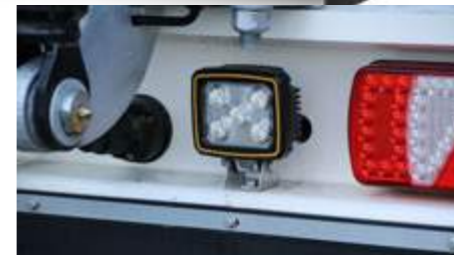
Phares LED installés sur la face arrière.
