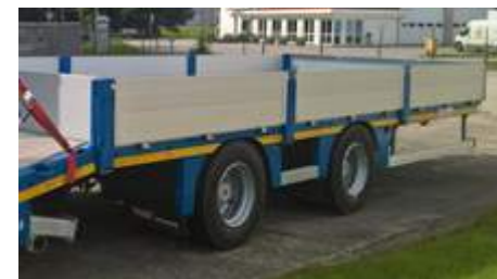
Ridelles rabattables en ALU, d'une hauteur de ± 400 mm.
