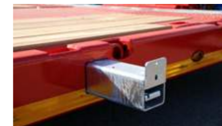
Elargisseurs galvanisés, extensibles d'env. 230mm par côté.
