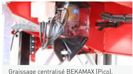
Graissage centralisé BEKAMAX (Pico), graisse normale NLGI-2 avec protection amovible autour de la pompe.[MAX110]
