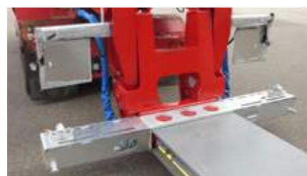
Une traverse galvanisée amovible avec 1 paires de pochettes conteneur WADER. Fixations conteneurs WADER.
