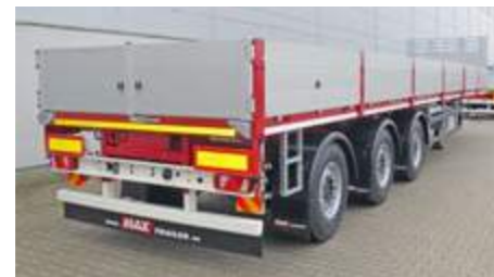
Ridelles rabattables en ALU, hauteur ± 600mm, avec ranchers rabattables KINNEGRIP.
