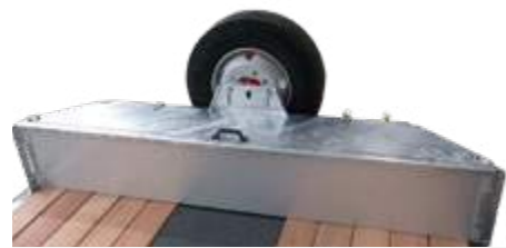
Une caisse à outils galvanisée intégrée dans la rallonge chanfreinée du col de cygne.
