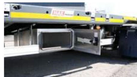
Caisse à outils INOX droite 565 x 290 x 810mm.
