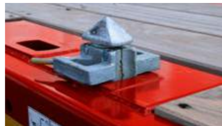
Pochettes conteneur WADER dans le plateau de chargement.
