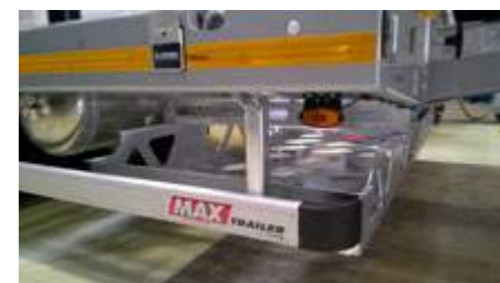
Un bac de rangement galvanisé en dessous du plateau de chargement. (2.410 x 1.025).
