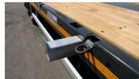
Elargisseurs galvanisés, extensibles d'env. 230mm par côté.
