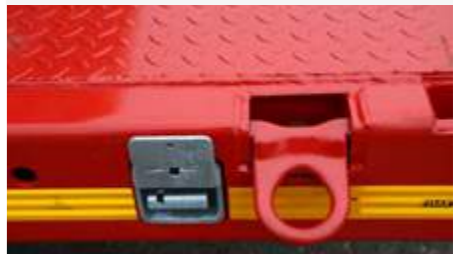
Anneau d'arrimage 10t rabattable vers l'extérieur.
