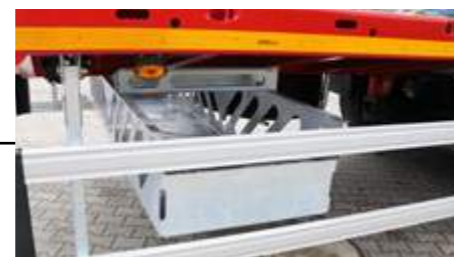
Un bac de rangement galvanisé en dessous du plateau de chargement (2.430 x 770 x 400mm).
