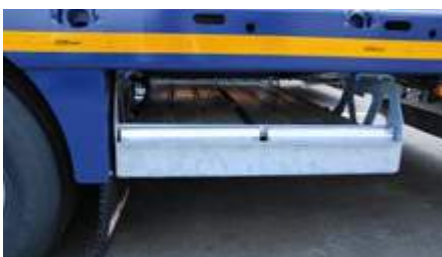
Support pour rampes en alu, installé transversalement derrière le bogie d'essieux.
