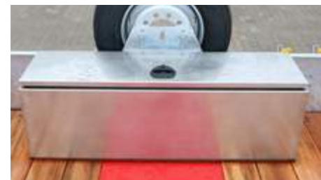
Une caisse à outils (INOX) sur le col de cygne env. 1.350 x 400 x 400mm.
