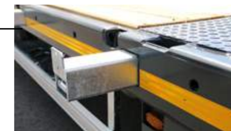
Elargisseurs galvanisés, extensibles d'env. 230mm par côté.
