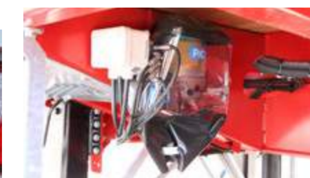
Graissage centralisé BEKAMAX (Pico) avec graisse normale NLGI-2 avec protection amovible autour de la pompe.
