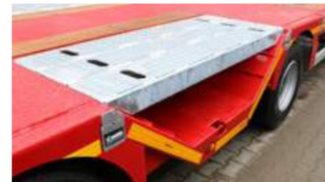
Recouvrement de fosse à roues.
