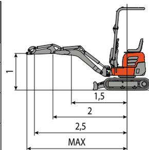
La capacité de levage est basée sur la norme ISO 10567 et elle ne dépasse pas au-delà du 75% du charge statique de basculement ou au-delà du 87% de la capacité de levage hydraulique de la machine.
