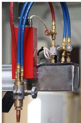
Le kit de coupe d'oxycoupage de la PNC-12 EXTREME est doté naturellement d'un chalumeau KOIKE de grande qualité et de valve solénoïd On/off sur chaque gaz ce qui permet un pré-réglage de la flamme et une séquence automatique de perçage. De plus, des buses KOIKE D7 à grande vitesse coupe sont incluses dans le kit.
