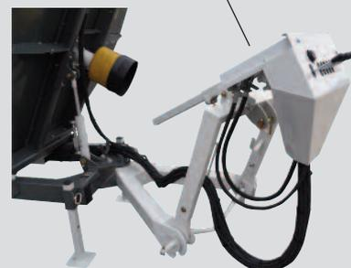
**Attelage articulé** avec cadre support du distributeur hydraulique inclinable relié au 3<sup>ème</sup> point du tracteur. La DP180 suit les mouvements et le trajet du tracteur.
