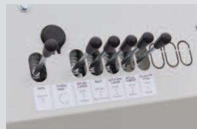
**Distributeur hydraulique** avec diviseur de débit réglable pour la vitesse du tapis
