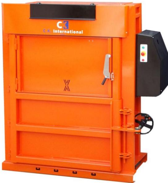
La presse à balles CK300VX possède un design compact et une faible hauteur de machine, ce qui facilite son transport et son installation. Le temps de cycle est rapide, le niveau sonore est faible, le chargement des bobines de liens se fait à l'avant de la machine pour faciliter leurs remplacements. Le poids de balle (carton) atteint les 300kg. 30 Tonnes de force de compaction. Idéale pour obtenir des balles denses de déchets plastiques, de papier broyé, ou de carton. Ligature à 4 liens.
