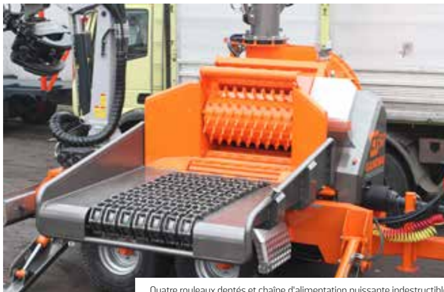
Quatre rouleaux dentés et chaîne d'alimentation puissante indestructible
