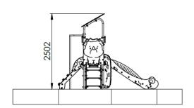
Potegux inox RONDS Ø42.4 mm Plancher HDPE Panneaux et toits HDPE Cordage Armé polypropylène 16mm
