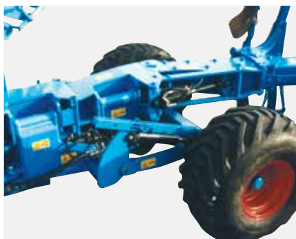
Le bâti articulé
