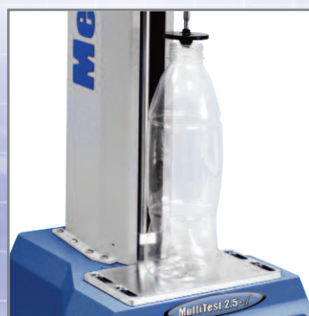
Test de compression axiale
