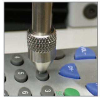
Test sur touches de commande
