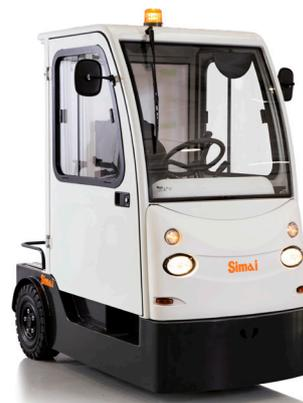
Tracteur à 3 roues, homme à bord, avec traction arrière. Extrêmement maniable, idéal pour les services intensifs à l'intérieur et à l'extérieur. «AGV ready».
