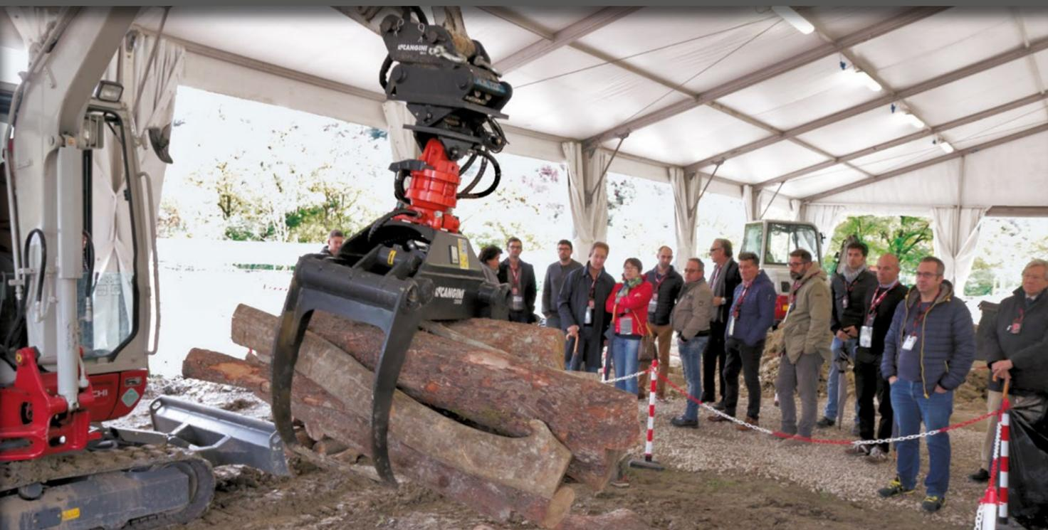
Rotation à 360°. Pièces d'usure en Domex 700. Valve de blocage fournie standard et montée sur le vérin de fermeture.
