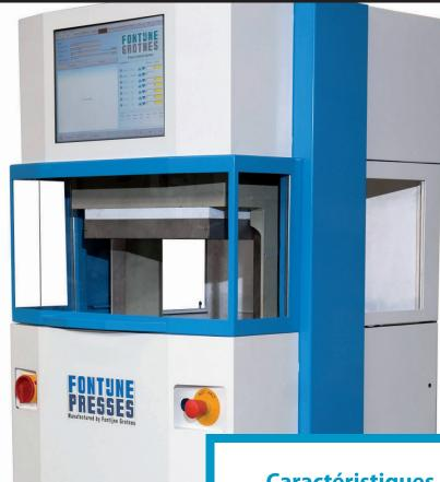
Les presses à plateaux chauffants Fontijne Grotnes sont utilisées pour étudier les procédés de fabrication des caoutchoucs, des plastiques et des composites. Celles-ci permettent la fabrication des éprouvettes pour la recherche et le contrôle qualité.
