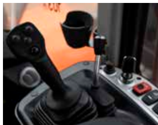
Manipulateur avec molette électro-proportionnelle et contacteur AV / PM / AR
