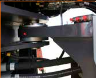
Graisseurs et connexions des flexibles bien placés et facilement accessibles
