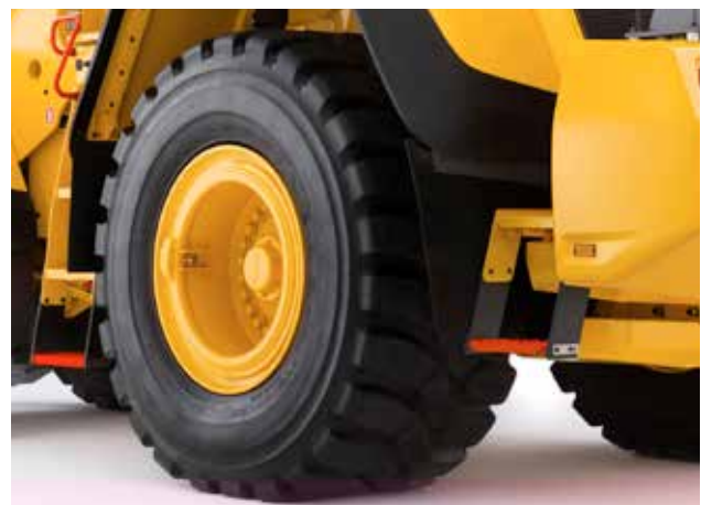
Pneus arrière avec ballast liquide
