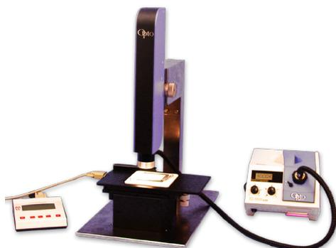
Le Cleanalyzer version «Advanced» est composé d'une optique à grossissement fixe qui le rend parfaitement adapté au traitement de petites quantités de filtres (5 à 10 filtres par jour).
