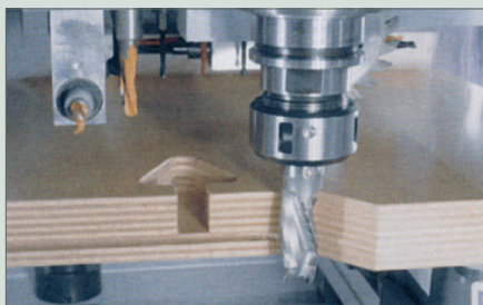
Défonçage et perçage
