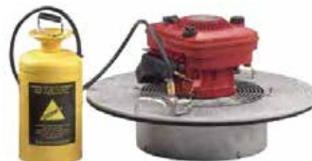
Pour contrôler la conformité des branchements aux réseaux d'eaux usées et d'eaux pluviales.
