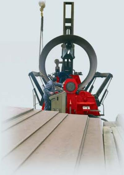
Le bord du cône est pointé dans la machine, une caractéristique très utile sur des pièces de grand diamètre et sur l'épaisseur de matériaux lourds
