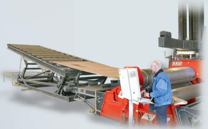
En phase de pré-plier le bord d'attaque
