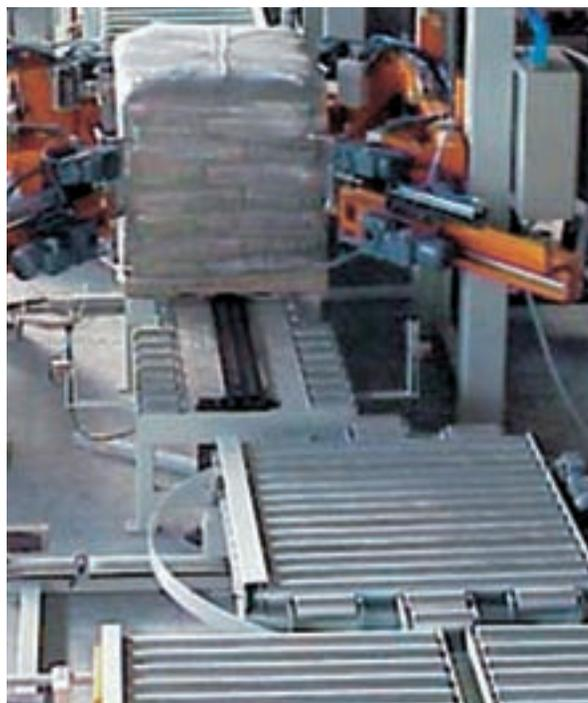
Les housseuses **Metral**<sup>®</sup> peuvent fonctionner avec des palettes rectangulaires ou carrées. Nous disposons de modèles à réglage motorisée qui réalisent automatiquement une opération carrée ou rectangulaire.
