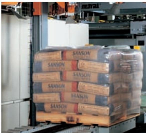
La finition impeccable de la palette protégée grâce à sa housse extensible fixe la charge et lui permet de résister aux manipulations à l'usine, pendant le transport en camion et le stockage aux intempéries.
