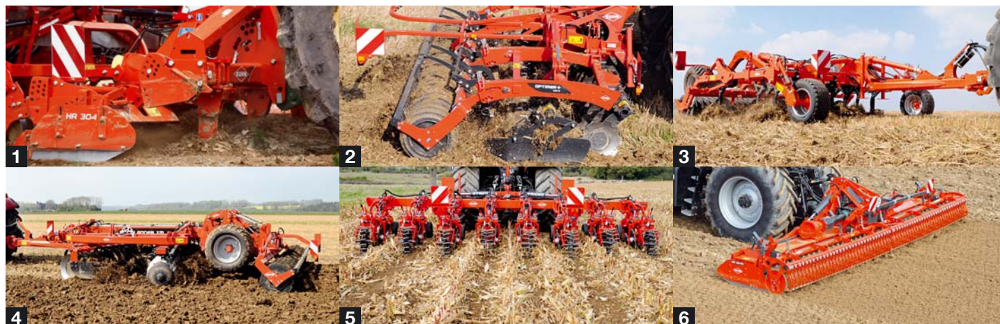
1. Décompacteurs - 2. Déchaumeurs à disques - 3. Déchaumeurs à dents - 4. Déchaumeurs à disques type cover crop - 5. Strip-till - 6. Herses rotatives
