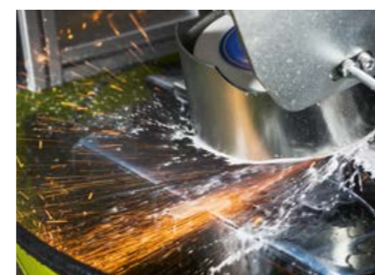
Grâce à l'angle d'affûtage idéal, le rayon et les contours du couteau sont préservés.
