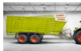
Le timon hydraulique permet de relever et d'abaisser au maximum l'ensemble de la remorque.
