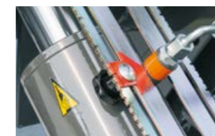
Flèche-repère indiquant que le timon est à l'horizontale.
