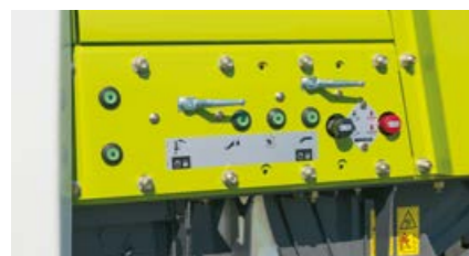
Toutes les commandes sont directement sur la remorque.
