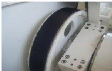
Nouveau système protégé par brevet. Il permet une synchronisation et un équilibrage automatique de l'axe principal et des roulements. Cette innovation réduit significativement les vibrations et garantit ainsi une longévité optimale de votre concasseur. Produit exclusif chez GENERAL TP.
