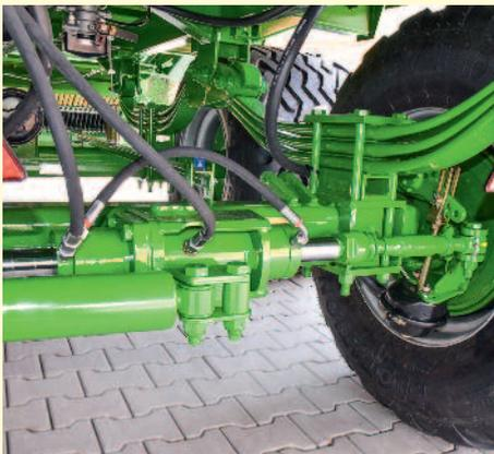
Dans les terrains accidentés et dans les pentes vous conservez toujours le contrôle grâce au solide châssis de l'autochargeuse **REPEX**. Les ressorts paraboliques triples assurent des mouvements d'essieux stables tout en assurant une excellente tenue de route. Par conséquent, même à pleine charge vous obtenez une excellente cadence de récolte. Les pneumatiques (710/45 R 22.5 maxi) offrent une large surface d'appui et donc une pression au sol minimale.
