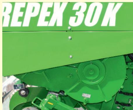
Le rotor est entraîné par un robuste et puissant engrenage à pignon droit pratiquement exempt de maintenance. Des dents de transport massives disposées en spirale transportent le fourrage uniformément et aisément dans l'espace de chargement via le canal de coupe. La puissance d'entraînement est réduite grâce au fond mouvant abaissé et au canal de transport ainsi raccourci, ce qui permet de ne pas abîmer le fourrage, d'où économie de coûts et qualité accrue de votre fourrage.
