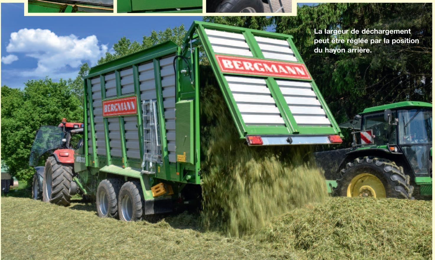
La largeur de déchargement peut être réglée par la position du hayon arrière.
