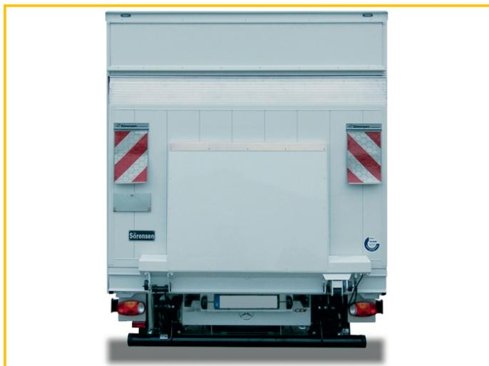
L'élévateur à ciseaux intégré dans la plate-forme soulève la charge horizontalement jusqu'à 520 mm au-dessus du seuil du véhicule.
